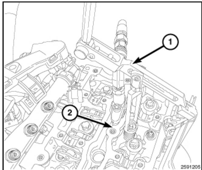
3. 压缩气门 (3)，并拆卸气门保持器 (1)。
